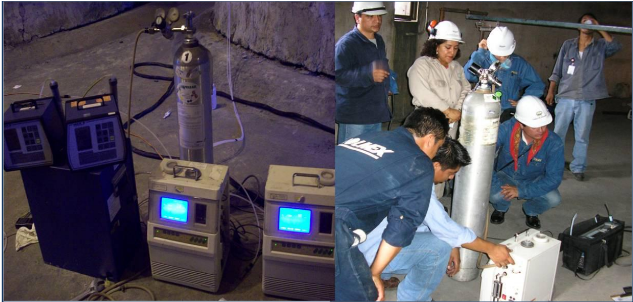
Figura 3.3. Calibración de los equipos de muestreo de gases en la Central Termoelectrica.
