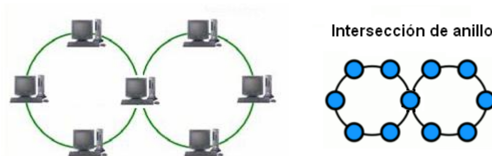
Figura 2.6 Red con topología en intersección de anillo.
