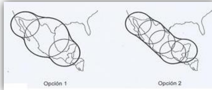
Figura 4.8 Ejemplo de dos posibles coberturas del territorio mexicano con huellas generadas con por un paraboloide con un arreglo de cornetas.
