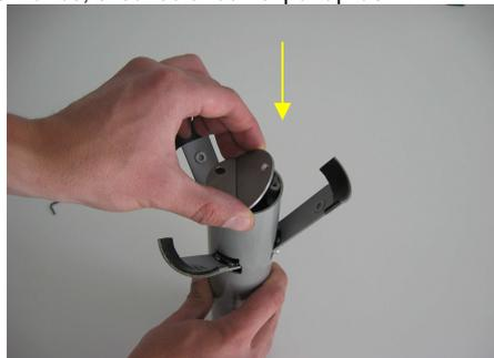
Fotografía 58. Ahora se coloca nuevamente la tapa, el tornillo y finalmente se atornilla como en la foto 53.
