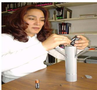
5. Las baterías se colocan en el porta pilas.
