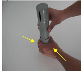
**Fotografía 67.** Y finalmente se pliegan los soportes.
