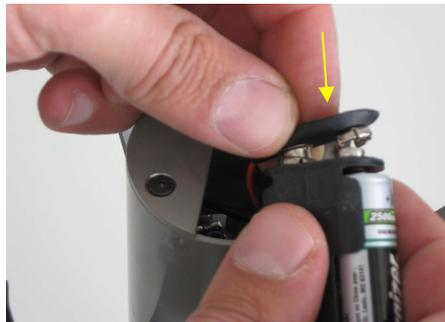
Fotografía 56. Hay suficiente estabilidad para conectar con ambas manos, el conector con el portapilas.
