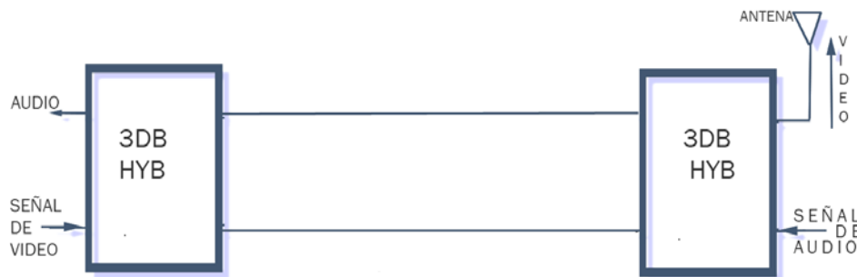
FIGURA 1.25 Proceso de la señal de audio en el arreglo Back to Back
