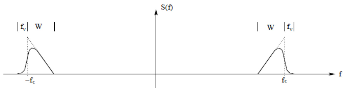
FIGURA B.2 Espectro de la señal VSB con banda residual superior
