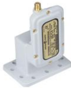
Fig. II.27, LNB que usa una frecuencia de entrada de: 3.4 a 4.2 GHz Frecuencia de salida de: 950 a 1,750 MHz.
