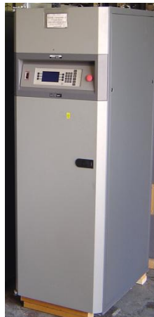
Fig. II.15. Hpa de kistron con un rango de: 12.75 a 13.25GHz 2,000 Watts o 13.75 a 14.5GHz 2,000 Watts.
