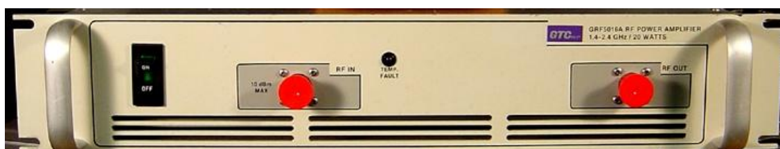
Fig. II.13. Amplificador de estado Sólido GTC RF Opera: 20 Watts 1.0 a 2.4GHz 120VAC.
