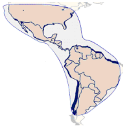
Fig. I.21. Zona de cobertura para el Satélite SATMEX 6 en banda C.
