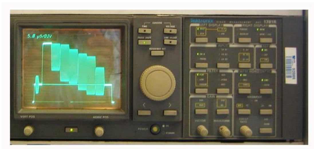
Fig.III.2. monitor de forma de onda con la señal de Tv compuesta.
