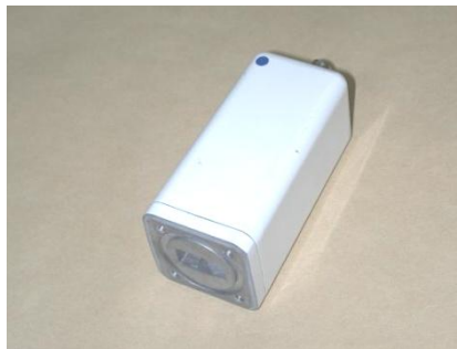
Fig. II.28. LNB.-convierte la señal recibida del satélite en Banda Ku en Banda L, Y la transfiere a la unidad de entrada.
