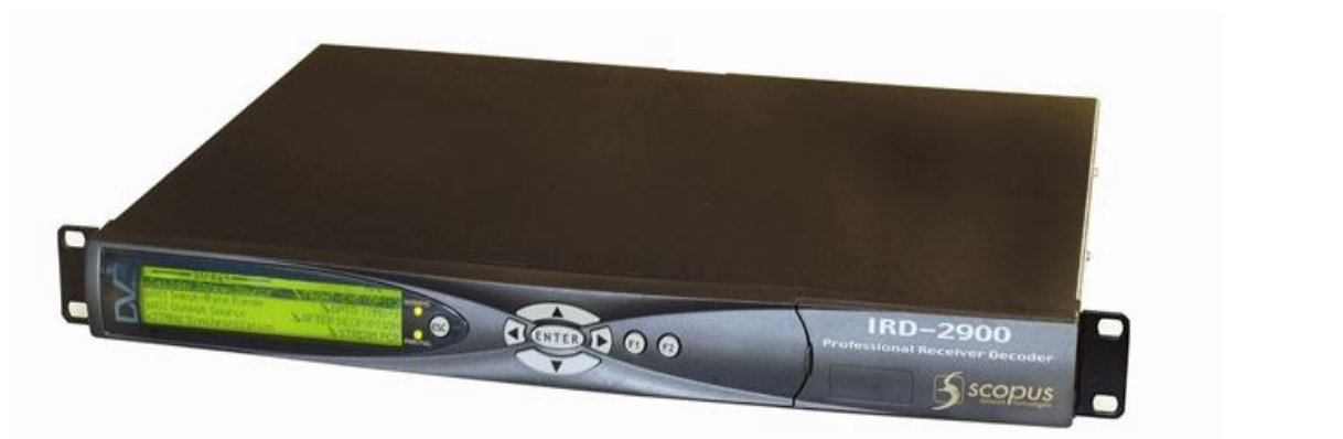
Fig. II.30. Receptor marca scopus que recibe, decodifica, descripta y procesa la señal recibida.
