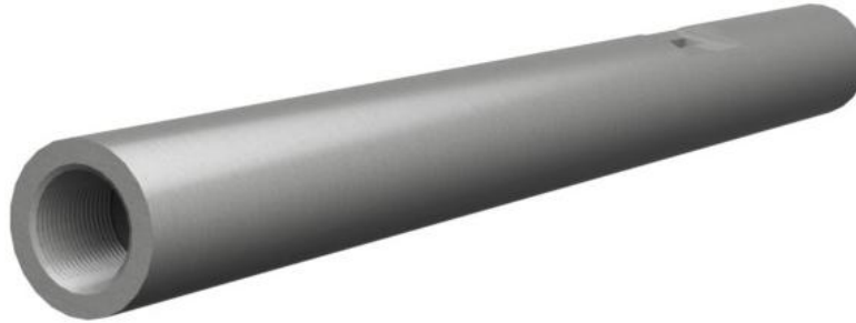
Figura 3-10 Cámara de plastificación diseñada.
