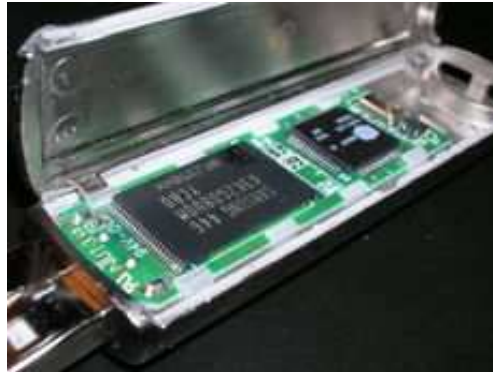
FIGURA II. 6. El microcontrolador a la derecha de la Memoria USB está controlada por un firmware empotrado.
