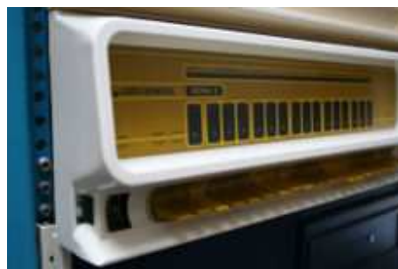
FIGURA II. 7. Interruptores para la carga manual en una Data General Nova 3.
