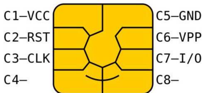
FIGURA IV. 10. Contactos del chip de una tarjeta con contactos.
