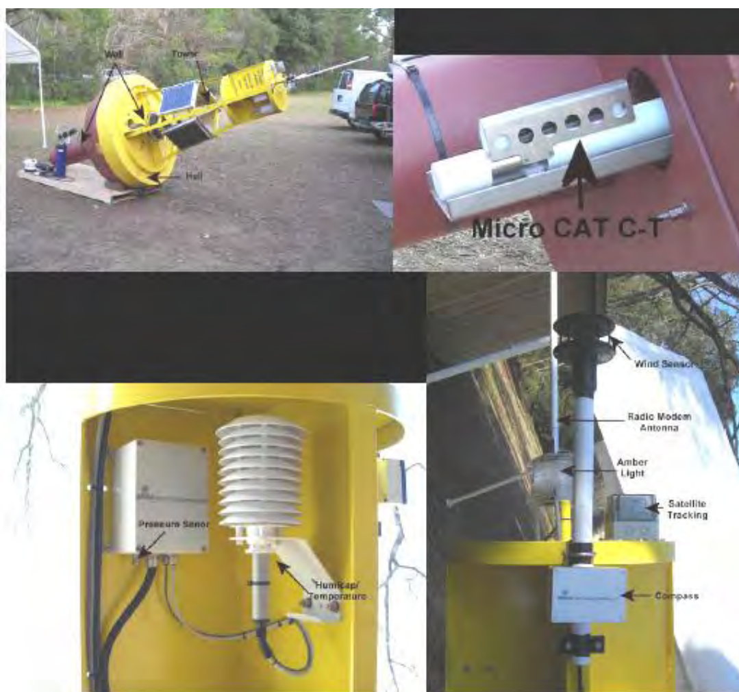
Figura 2.1 Instrumentación externa de la boya
