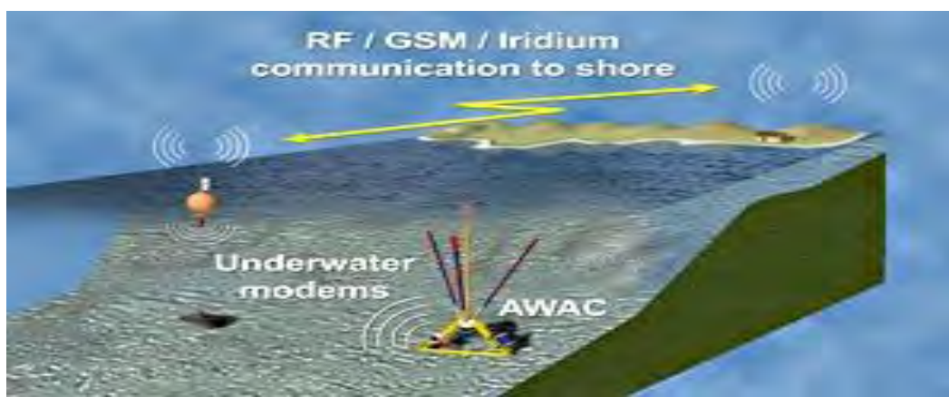
Figura 4.3 Esquema de comunicación
