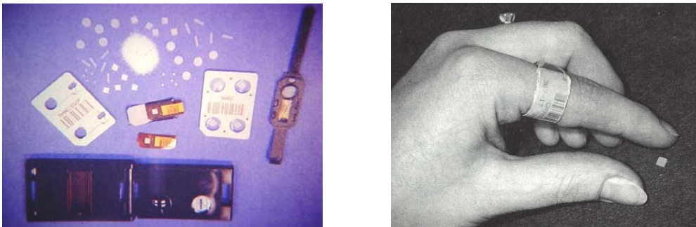
Figura 5. Características físicas de los dosímetros termoluminiscentes que serán usados en el estudio.
