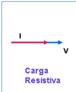
Figura 1.15. Voltaje y corriente en fase.
