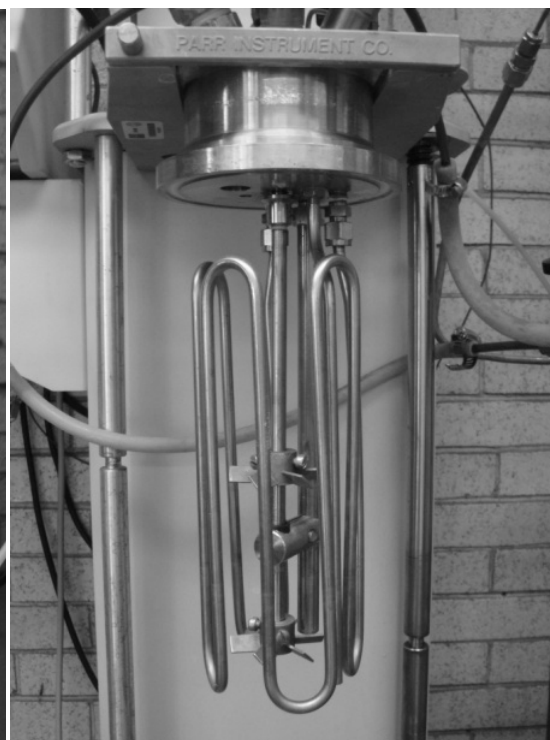
Figura 3.2. Serpentín de enfriamiento y sistema de agitación
