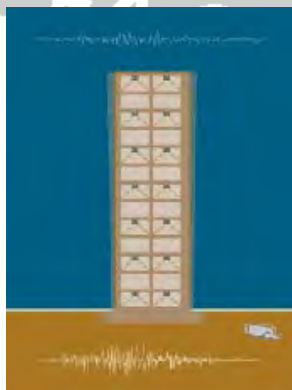
EDIFICIO SIN DISIPADORES
