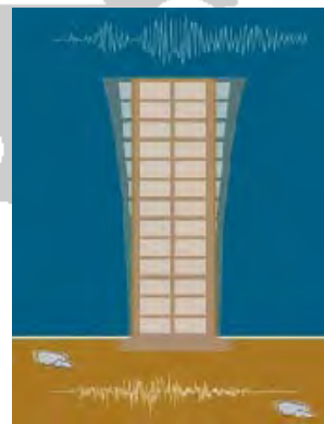
EDIFICIO CON DISIPADORES
