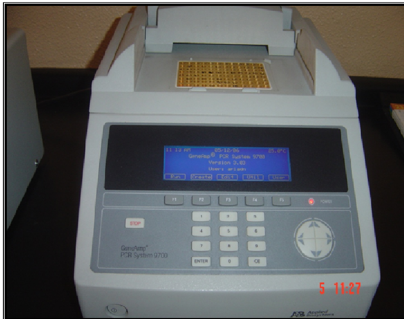
Fig.-9 Termociclador para PCR.
