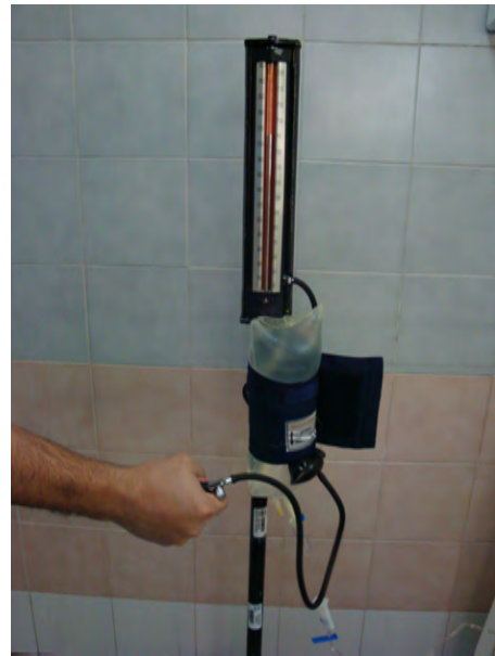
Fig. 11. Sistema para insuflar con esfigomanómetro a 200 mmHg.
