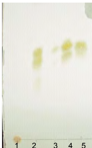
Figura 4.13: Reacción de desacetilación de la Rutina. 1: Rutina, 2: Rutina acetilada 3: Reacción de autohidrólisis, 4: Reacción con B. pumilus , 5: Reacción con C. antarctica
