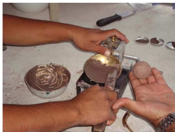
Colocación del material en la copa de casagrande
