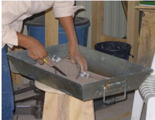
Extracción de la muestra para determinar contenido de humedad
