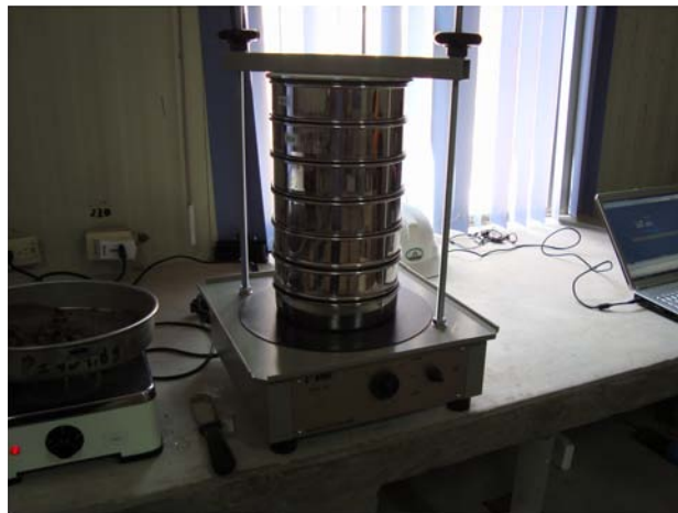
Cribado del material que pasa la malla N° 4
