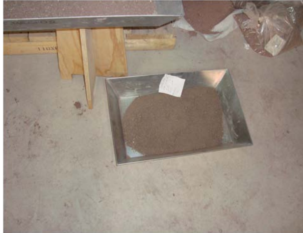
Muestra representativa de suelo para prueba de compactación
