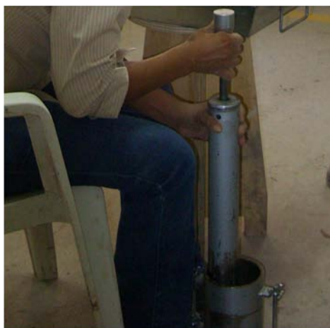
Compactación de material con el molde Proctor
