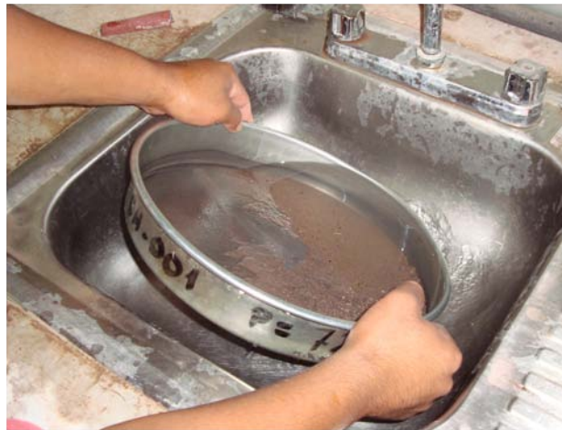
Decantación del material que pasa la malla N° 4
