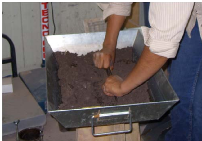
Disgregación de grumos
