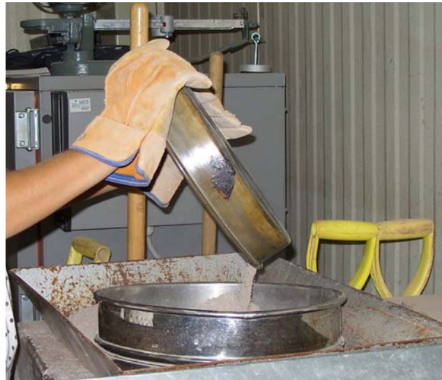
Cribado de las fracciones de material que pasa la malla N° 4
