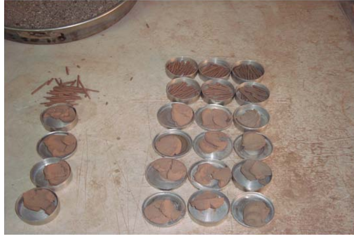
Muestras del límite líquido y plástico
