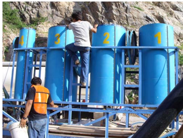
Revisión del nivel de agua de las buretas
