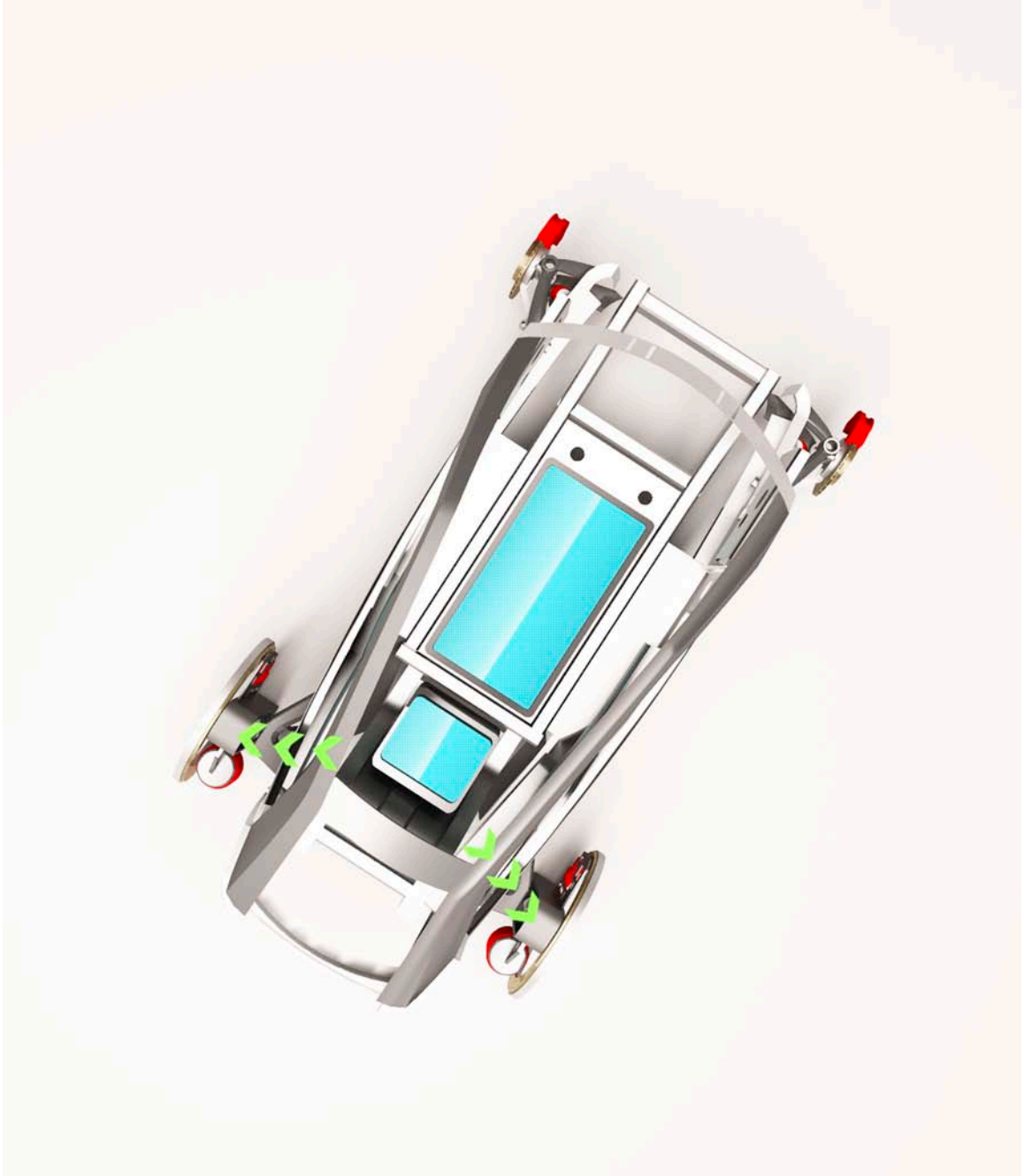
Ubicación del paquete de baterías dentro de la estructura general y como alimentan el par de motores eléctricos de las ruedas traseras
