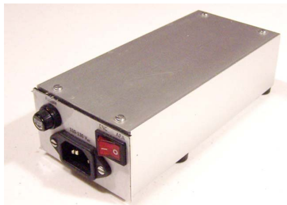
Figura 33. Fuente tipo buck diseñada en su caja de aluminio, con su interruptor principal, porta fusible y toma corriente.
