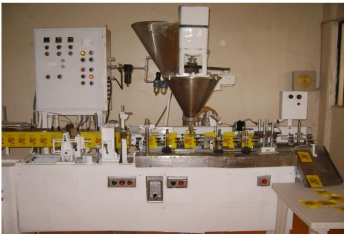
Figura 12b. Máquina ensobretadora
