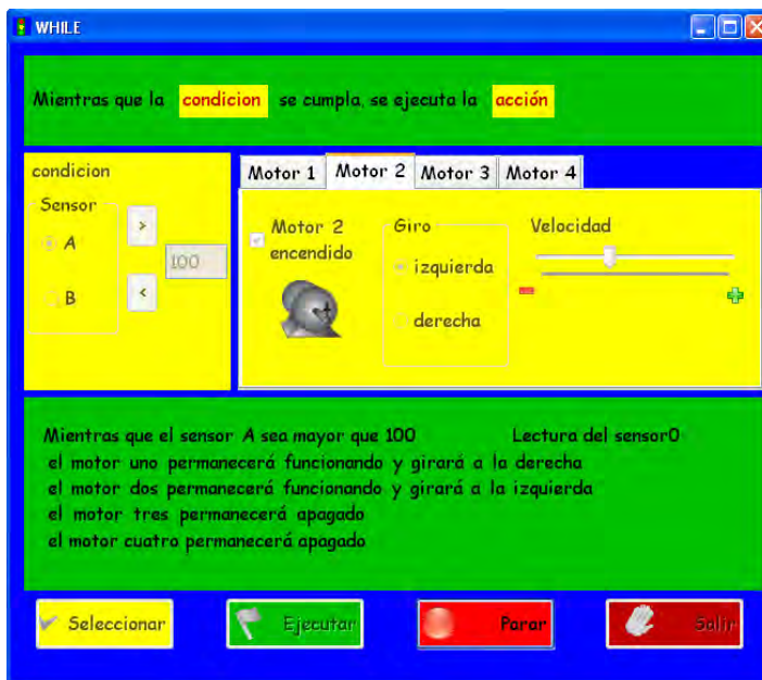
Figura 34 Ventana para la estructura while.
