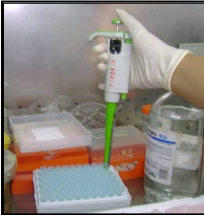
Imagen 2.- Micropipeta utilizada para realizar alícuotas (fotografía tomada en el Laboratorio de Histología tomada durante la realización de este proyecto).
