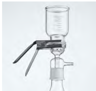
Figura 12. Sistema de filtración en CLAR
