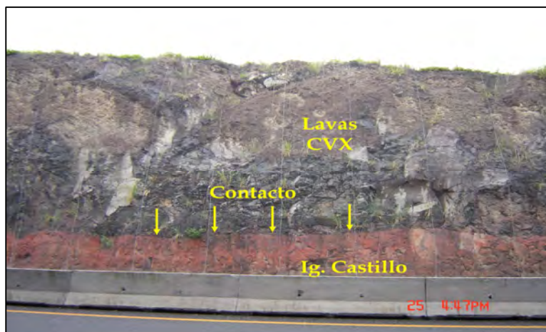
Figura 3.3 Derrames de lava cubriendo a la Ignimbrita El Castillo. Foto tomada en un corte sobre la autopista Xalapa-Veracruz.
