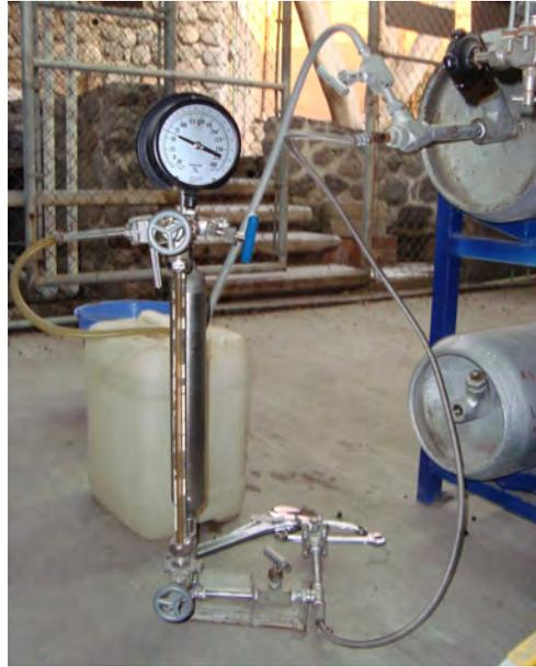
Figura 3.20. Llenado del tanque portátil de amoníaco
