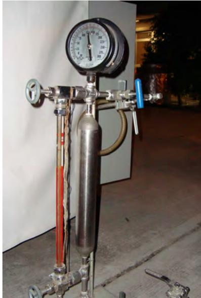
Figura 3.14. Tanque portátil de amoníaco
