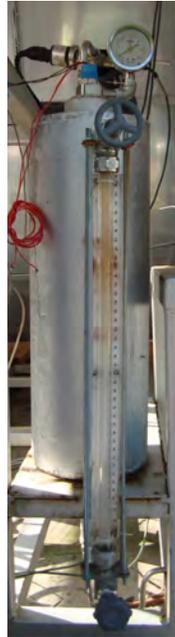
Figura 3.4. Tanque de condensado
