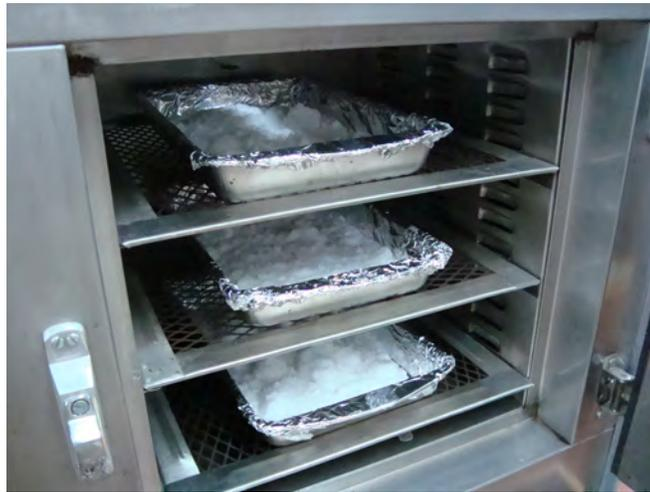
Figura 3.16.  $LiNO_3$  dentro del horno
