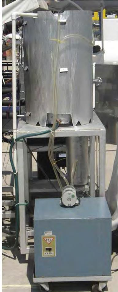
Figura 3.11. Control de temperatura de agua de enfriamiento
