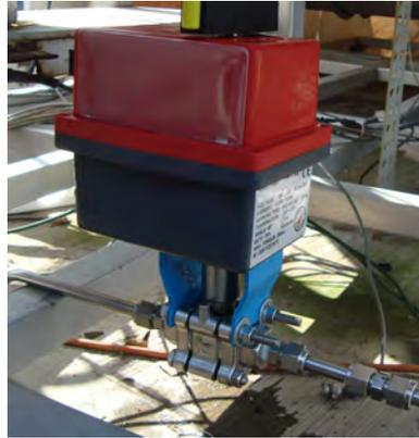
Figura 3.12. Actuador eléctrico J2 instalado en una válvula Worcester de 1/4 in
