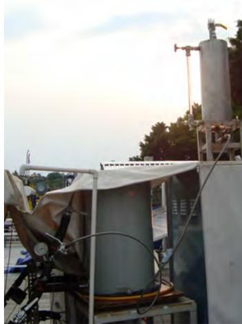
Figura 3.19. Carga de la solución hacia el equipo de refrigeración
