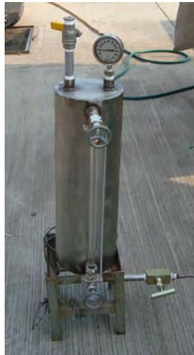
Figura 3.13. Tanque de carga de solución
