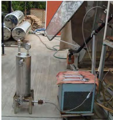
Figura 3.18. Carga de la solución por diferencia de alturas
