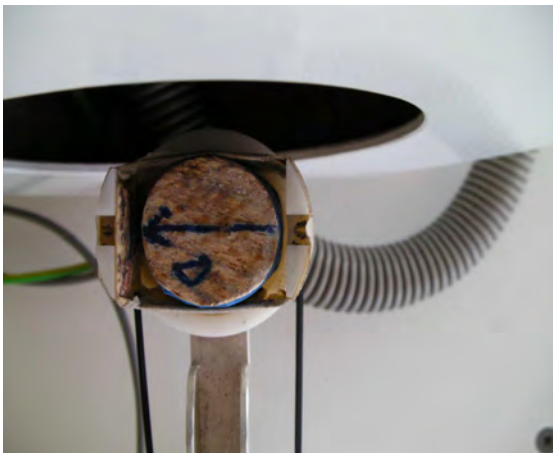
Figura 2.10. Posición 1 en el desmagnetizador (vista desde arriba)
