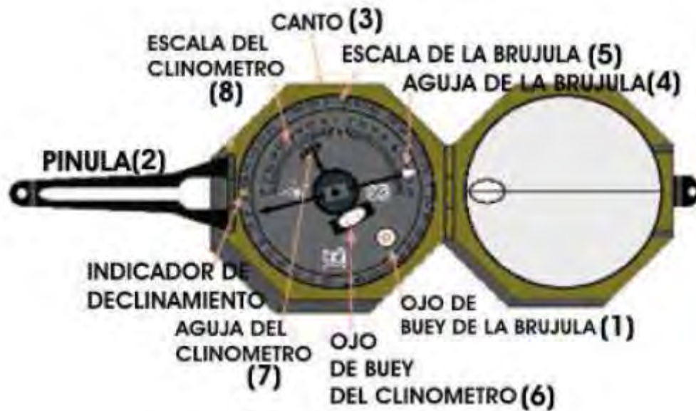
Figura 2.2 Partes de la brújula (Soler, 2006)
