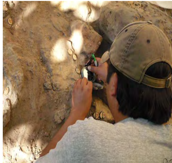
Figura 4.9. Orientación de la muestra LG06
