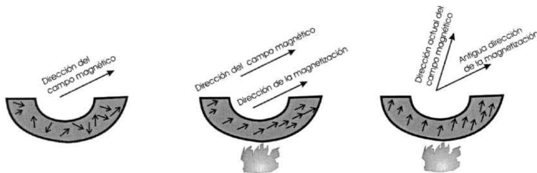
Figura 2.1 . Ilustración del proceso de adquisición de magnetización termoremanente en la pared de un horno (Soler, 2006)
