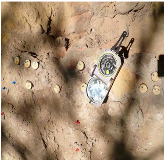
Figura 4.18. Brújula marcando el norte geográfico junto a la muestra LG10 antes de ser orientada
