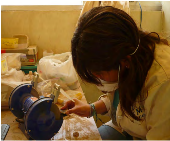
Figura 4.20. Preparación de las muestras, quitando el excedente con un esmeril de banco.
