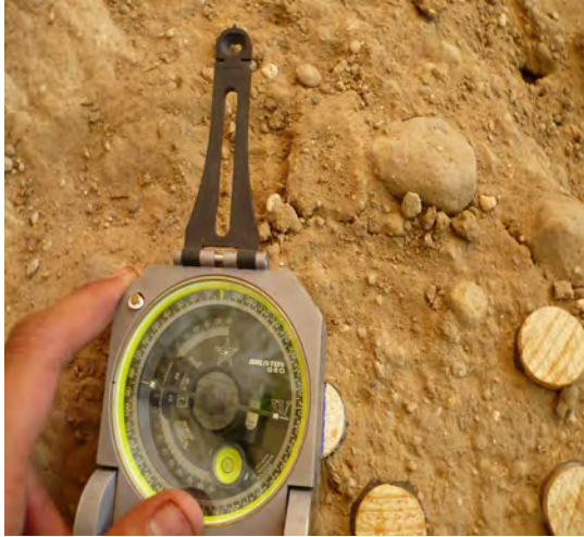
Figura 4.16. Orientando los testigos de la muestra LG09
