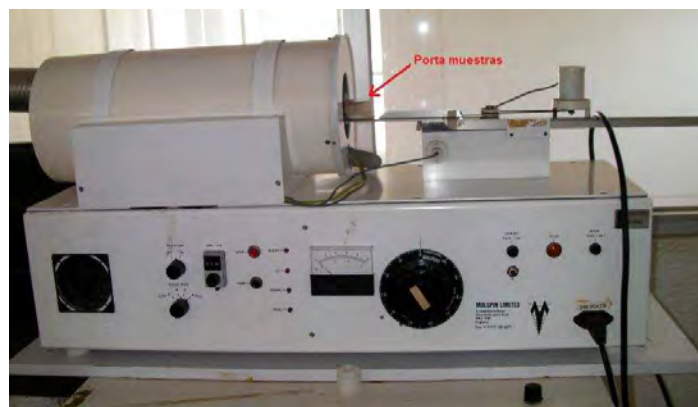
Figura 2.9 Desmagnetizador de campos alternos
