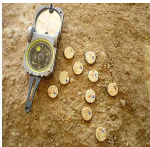
Figura 4.15. Brújula marcando el norte geográfico junto a la muestra LG08 antes de ser orientada
