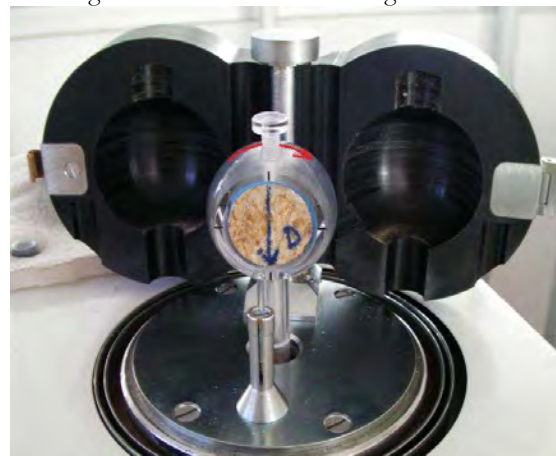
Figura 2.8. Posición 4 en el magnetómetro
