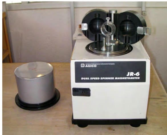
Figura 2.4. Magnetómetro de giro
