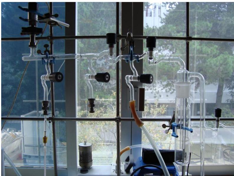
Imagen 4.1 Línea de vacío acondicionada
