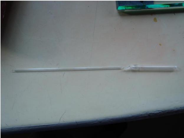
Imagen 4.3 Muestra de la forma en se sellaron las cápsulas de xenón
