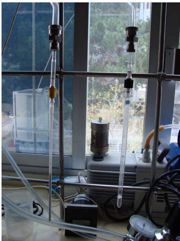
Imagen 4.2 Tubos, donde se desgasaron las muestras, conectados a la rampa de vacío.
