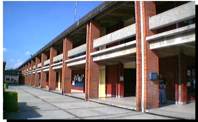
En algunos de los laboratorios existe el inconveniente de la penetración solar directa, esta se evita colocando cortinas de un color oscuro, aunque esta es una solución; no descarta que su orientación fue la más inadecuada.
