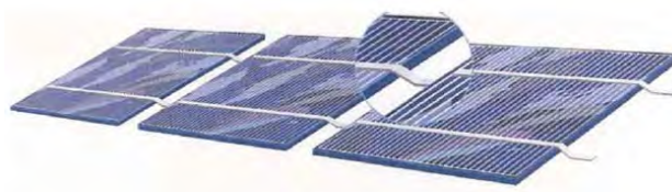
Figura 2.8 Vista detallada de la conexión en serie de las celdas fotovoltaicas.
