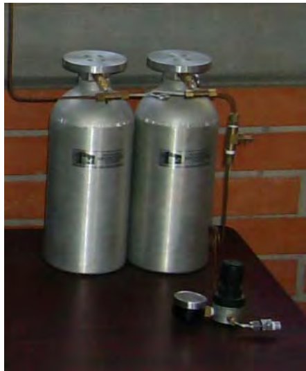
Figura 4.40 Conexiones mecánicas del sistema de almacenamiento de hidruro metálico.
