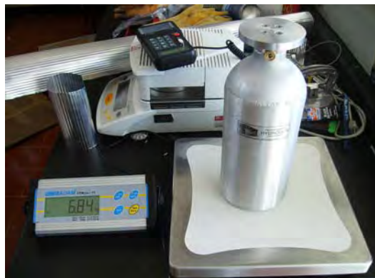
Figura 4.24 Medición del incremento de masa del tanque de hidruro con una báscula de 20 g de resolución.
