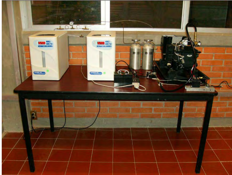
Figura 5.2 Vista del sistema de electrólisis, almacenamiento de hidrógeno y celda de combustible.
