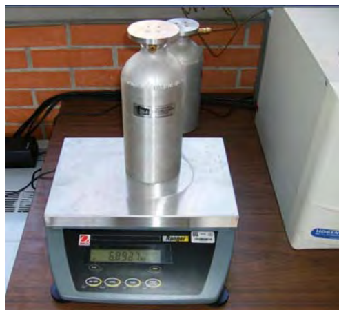
Figura 4.25 Medición del incremento de masa del tanque de hidruro con la báscula RD35LM.
