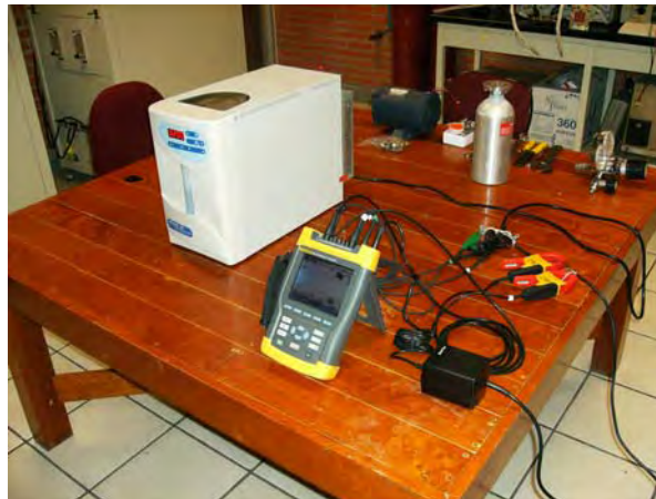
Figura 4.29 Caracterización del consumo eléctrico del electrolizador para obtener su eficiencia práctica.
