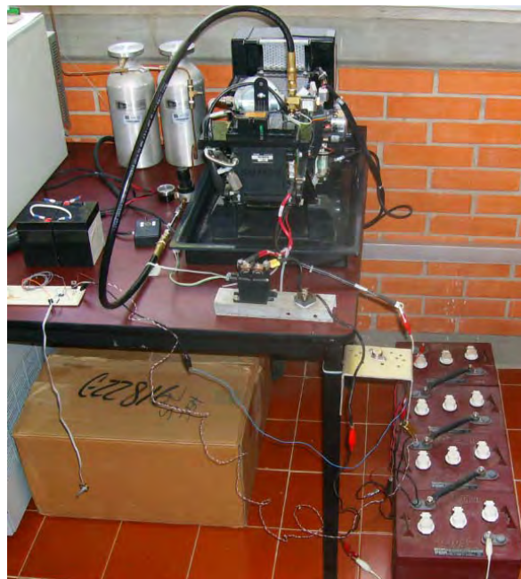
Figura 5.46 Integración y validación de las curva V-I de la celda de combustible Nexa de Ballard.
