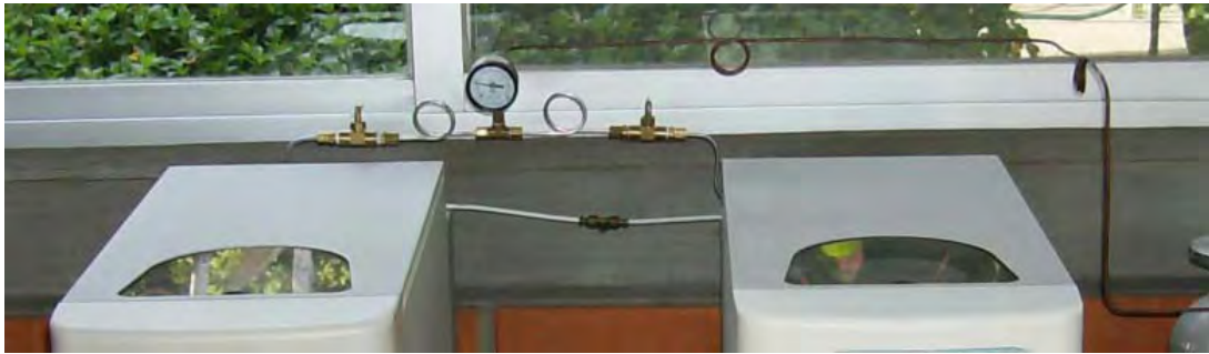
Figura 4.39 Conexiones mecánicas del sistema de electrólisis.
