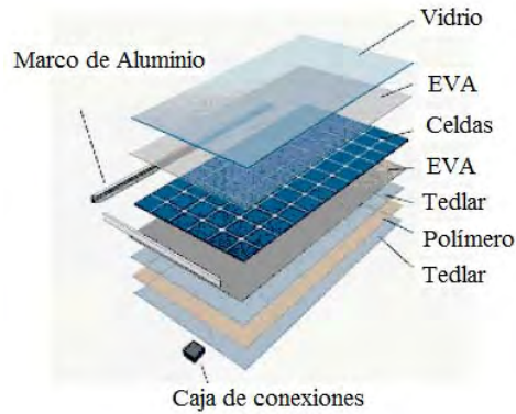
Figura 2.9 Construcción básica de un módulo o panel fotovoltaico.
