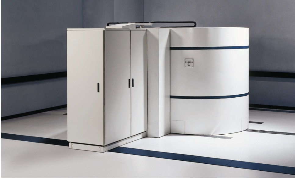
Figura 1.3a Ciclotrón modelo RDS-111 de Siemens
