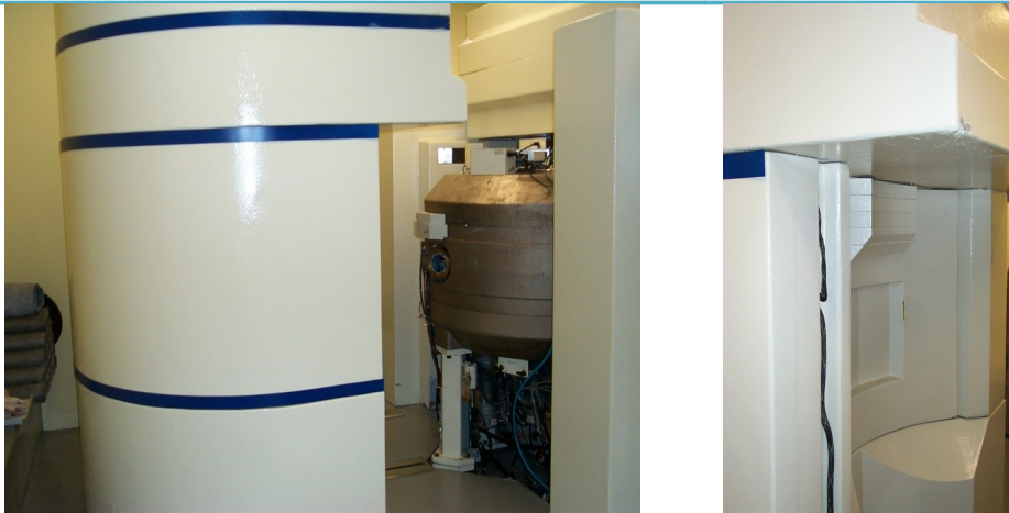
Figura 1.3.8b Izq: Blindaje del ciclotrón abierto y ciclotrón. Der: Interior del blindaje compuesto de carbono boratado.
