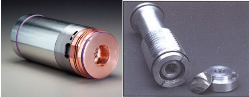
Figura 1.3.6 Contenedores del blanco. Izquierda: Blanco de Tantalio ( 60\mu\text{A} ), derecha: blanco de plata ( 40\mu\text{A} ).
