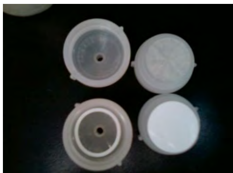
Figura 3.1. Imágenes de Swinnex con membrana, empaque y equipo de filtrado.
