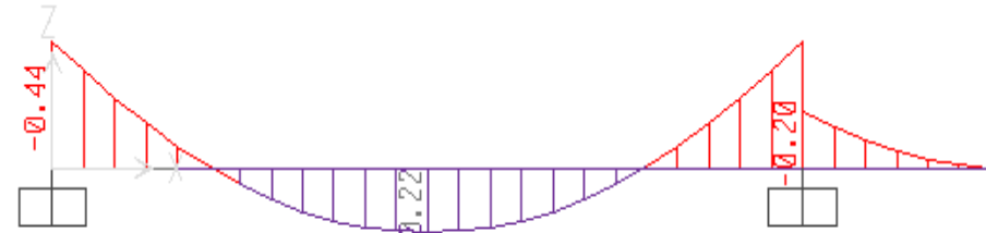
Diagrama de momentos obtenida con el programa sap
