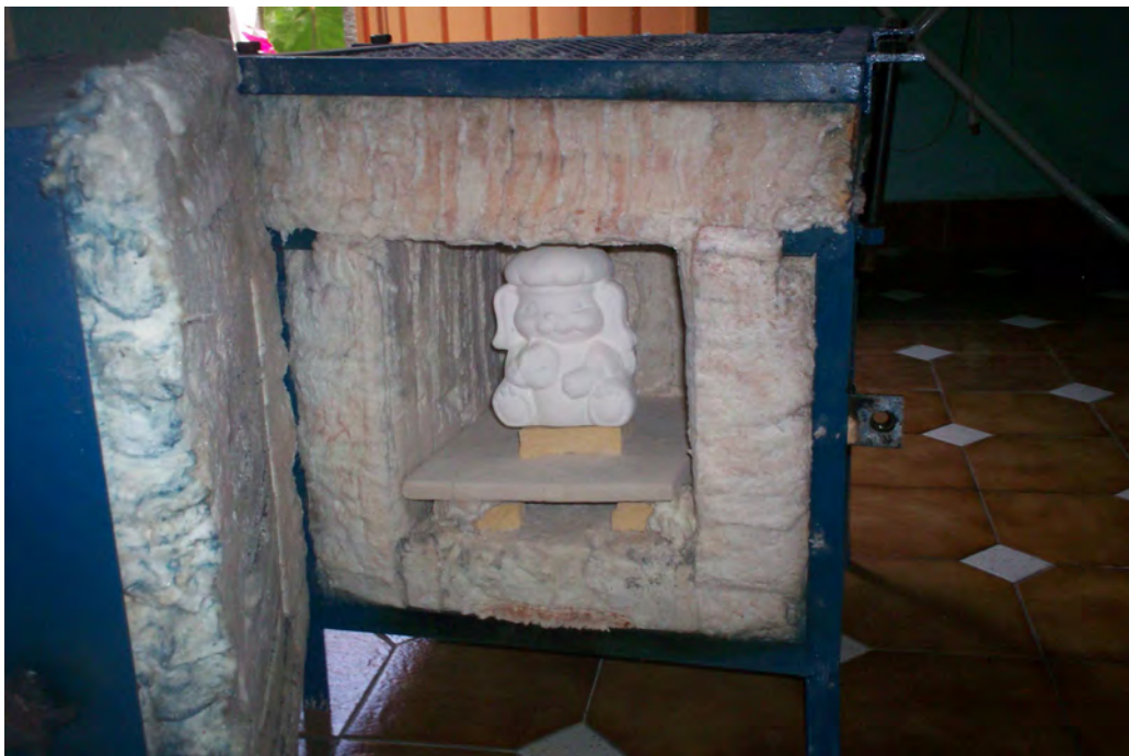
Figura 5.4: Pieza vidriada dentro del horno, para cocción.
