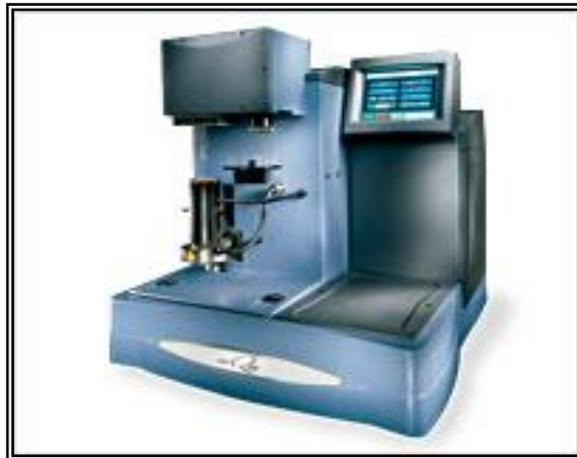
Figura 2.3. Termobalanza Q500HR.
