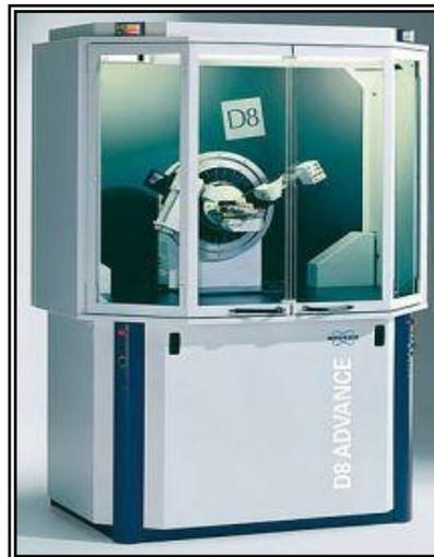
Figura 2.1. Difractómetro Bruker Axs, Advance D8.
