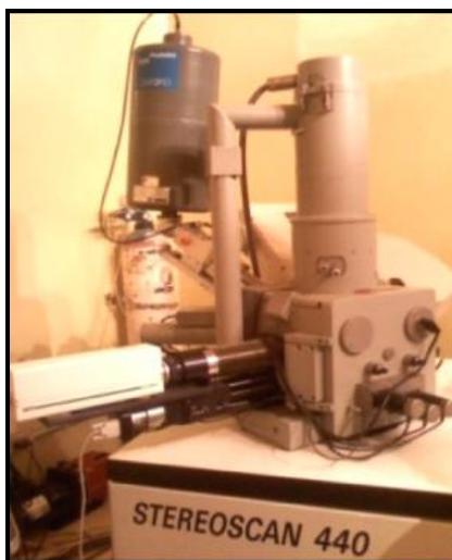
Figura 2.2. Microscopio Electrónico de Barrido.
