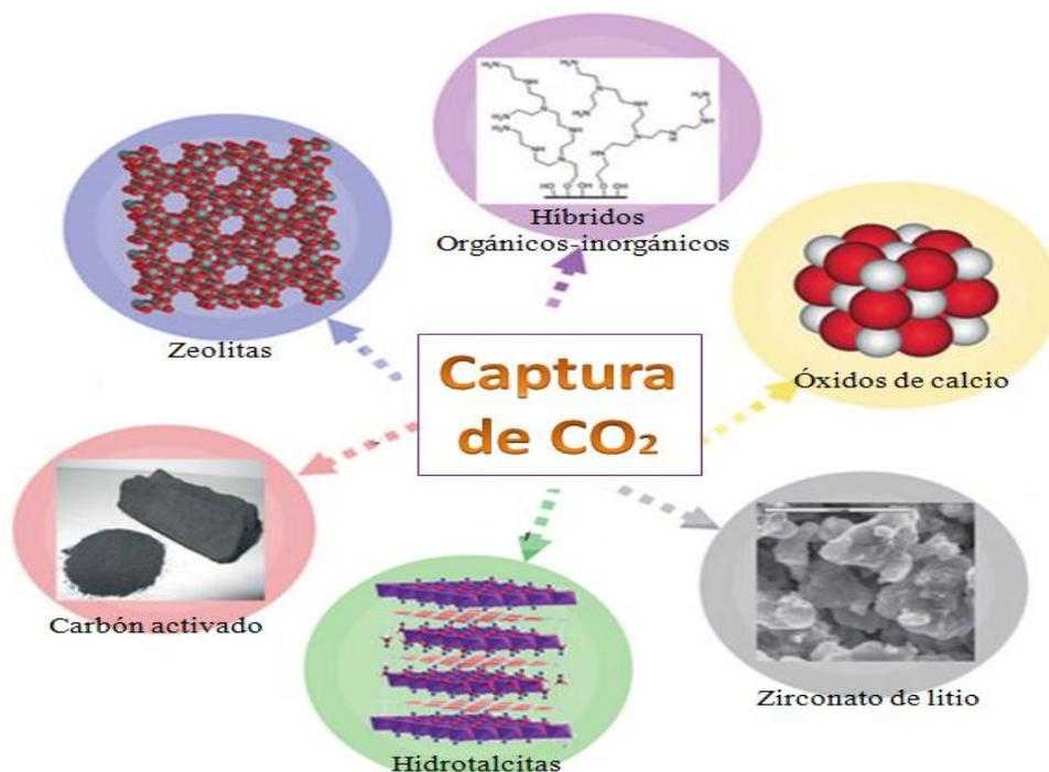
Figura 1.3. Algunos materiales usados en la captura de CO<sub>2</sub>.<sup>7</sup>
