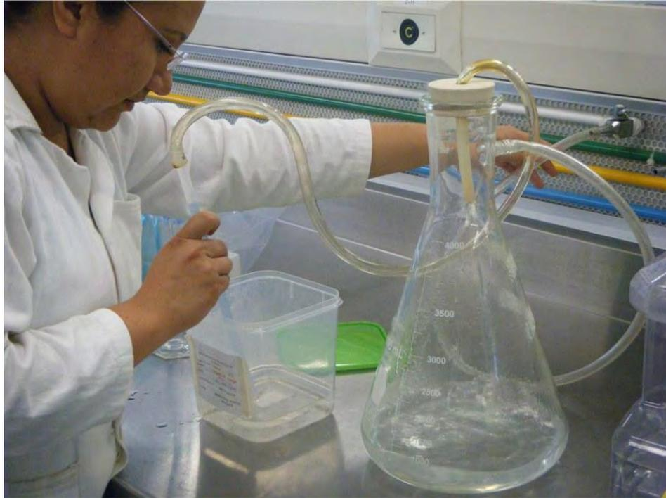
**Figura 25.** Aspiración por vacío del sobrenadante para la determinación de huevos de helminto.
