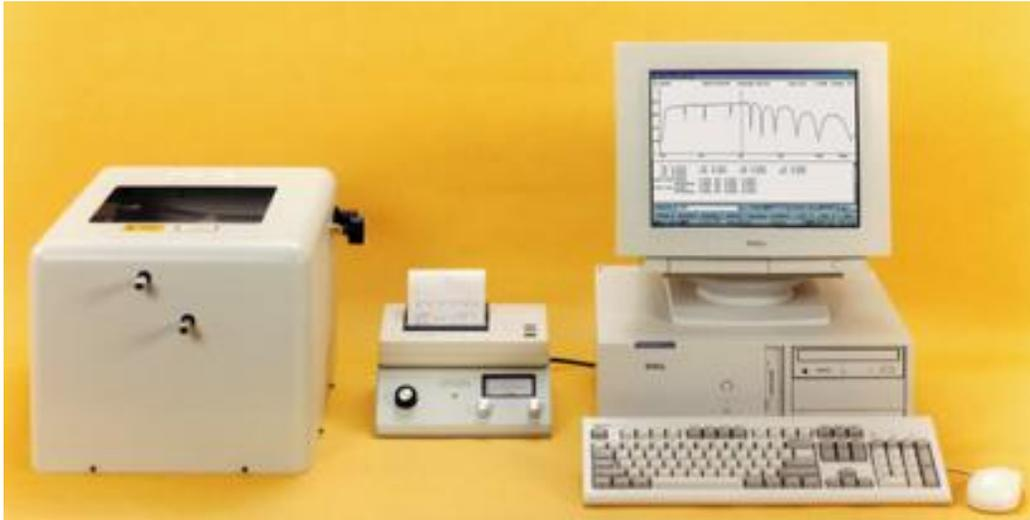
Figura 4.9. Montaje experimental para la prueba de acoplamiento con prisma de alto índice de refracción.
