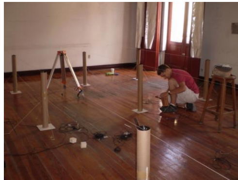
Imagen N° 78 Colocación de los fotómetros
