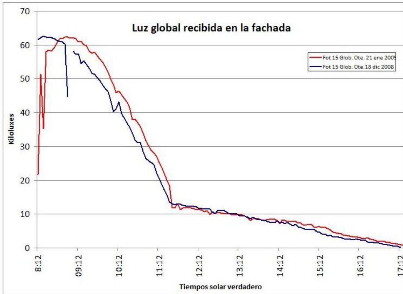
Gráfica N° 28. Comparación de los niveles de luz recibidos en la fachada de la maqueta.
