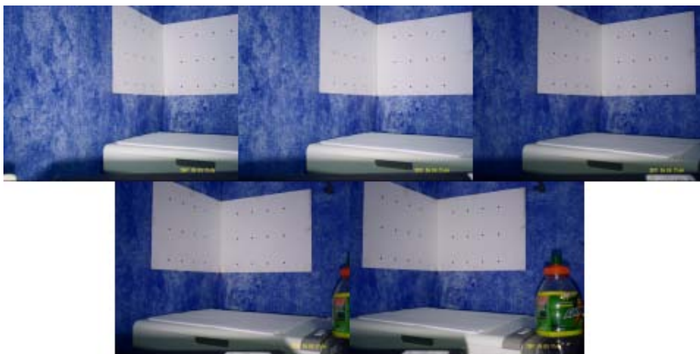
Figura 5.2: Conjunto de imágenes del patrón conocido en puntos de vista cambiados por movimiento únicamente de traslación.
