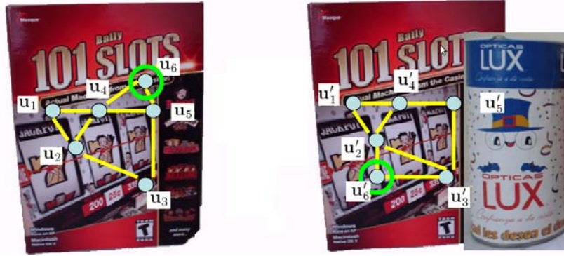
Figura 2.9: Gráficas iniciales generadas con una k = 2 . La correspondencia errónea esta marcada con un círculo azul [Aguilar, 2006].
