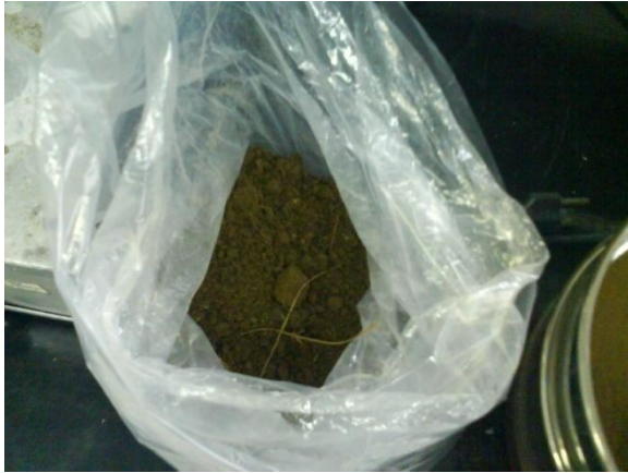
Figura 3.10 a) Extracción y secado previo de la muestra
