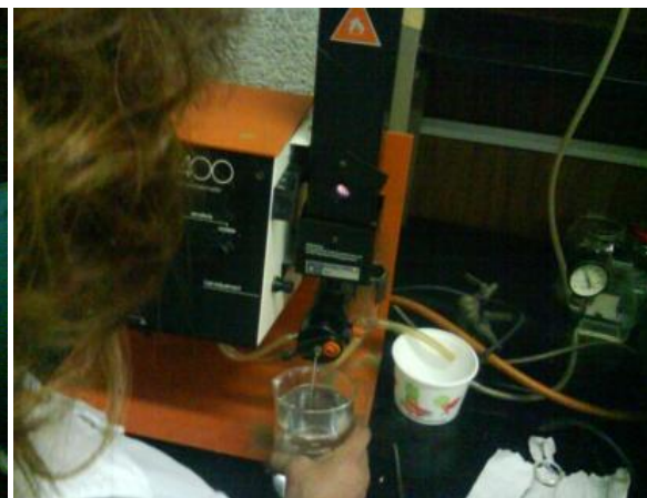
Figura 3.16.f) Limpieza con ácido nítrico
