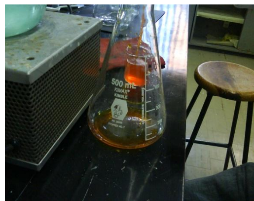
Figura 3.13.c) Adición del sulfato ferroso
