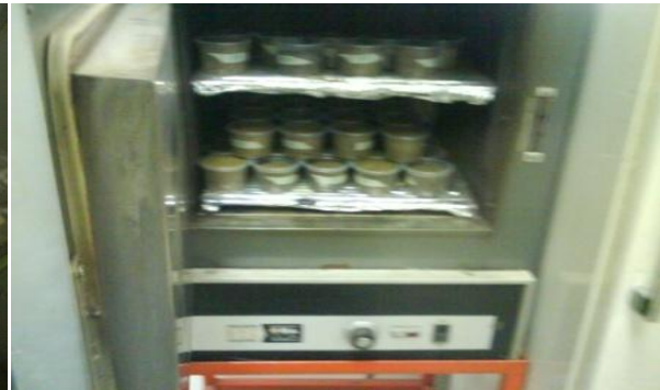
Figura 3.9 b) Secado en mofla a 105 °
