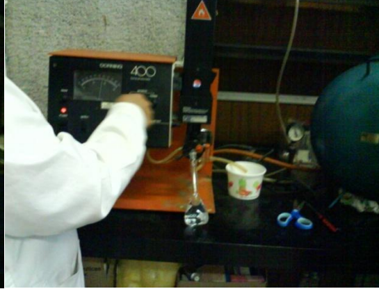
Figura 3.17.b) limpieza periódica con ácido entre lecturas
