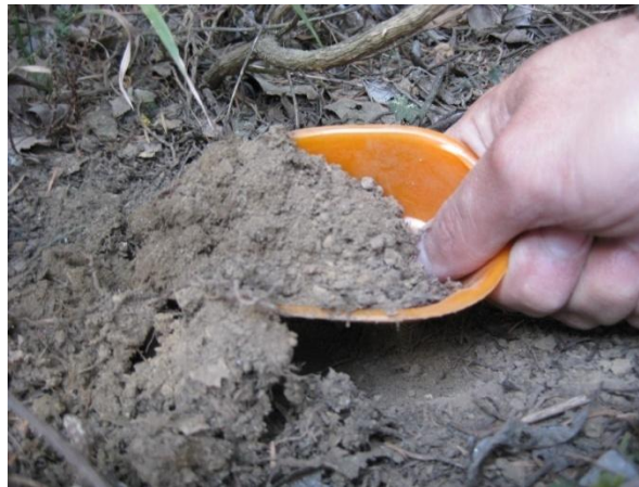
Figura 3.6 Muestreo con cucharilla de plástico
