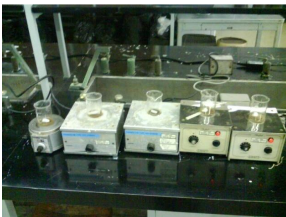
Figura 3.11 c) Agitación por aprox. 5 min
