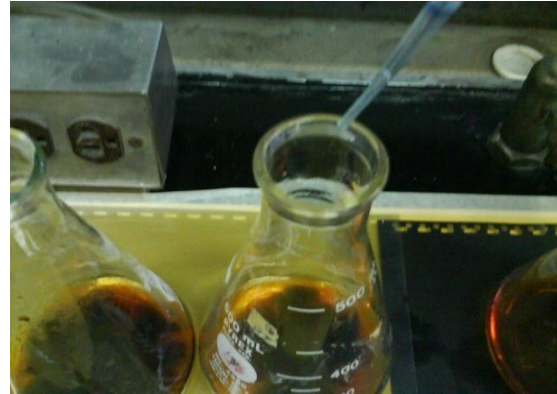
Figura 3.14.a) Agregando agua destilada y ácido fosfórico
