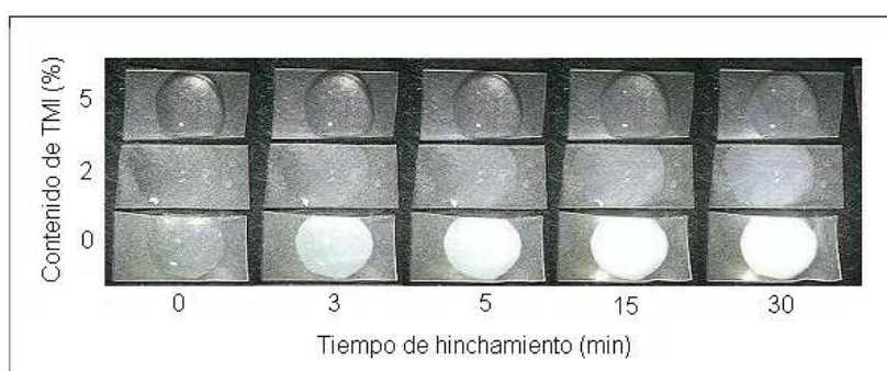
Figura 6.43 Efecto del contenido de TMI en películas de poli(VA/BA/TMI), sometidas a un proceso de entrecruzamiento acelerado, sobre la resistencia a la absorción de agua.
