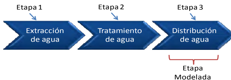
Figura 12. Tres etapas desde la extracción del agua hasta la distribución de agua
