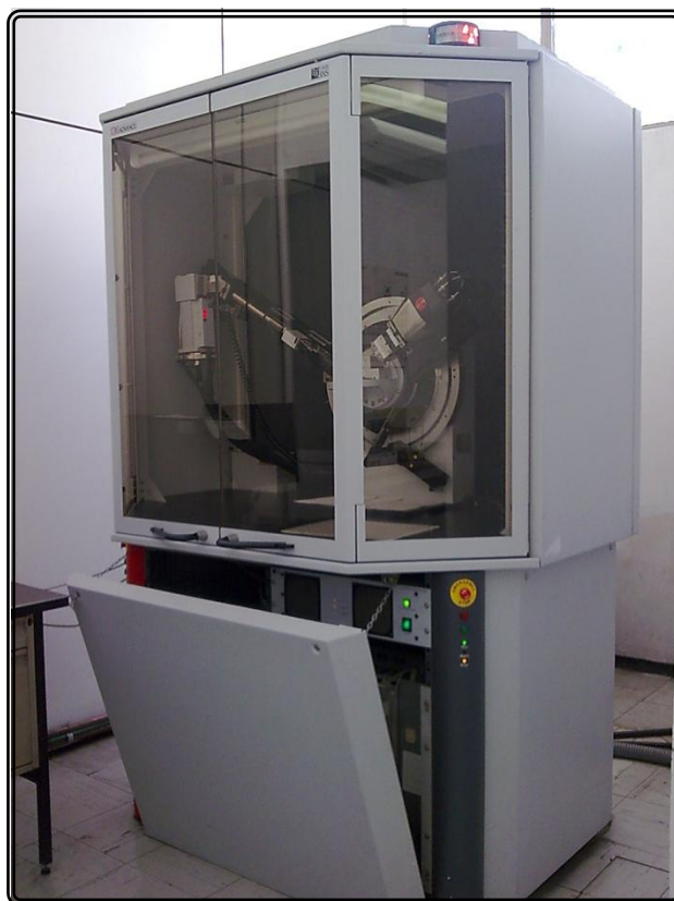
Figura 3.3 Difractómetro de rayos X Bruker D8 Advance con el que cuenta el Instituto de Investigaciones en Materiales, UNAM.
