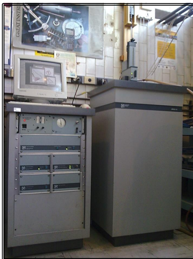
Figura 3.4 Magnetómetro tipo SQUID Quantum Design MPMS instalado en el laboratorio A-004 del Instituto de Investigaciones en Materiales, UNAM.
