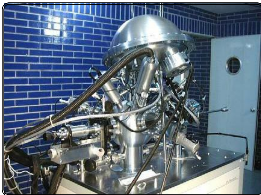
Figura A1.2 Espectrómetro de fotoelectrones de rayos X con el que cuenta el Instituto de Investigaciones en Materiales, UNAM.
