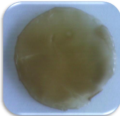
**Figura 8.** Película elaborada con 5% p/v de CP y 50 % p/p de sorbitol como plastificante
