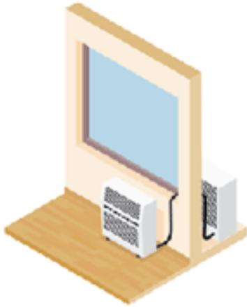
Instalación y funcionamiento. Tiene dos unidades, una exterior, tipo maleta, y otra interior. Se conectan a través de tuberías incorporadas a los equipos.
