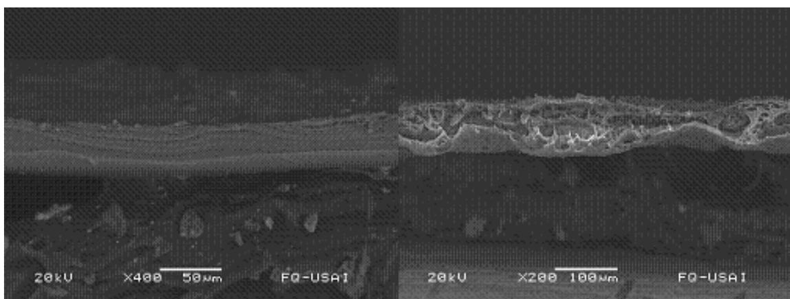
**Figura V.24. Comparación del corte transversal de una membrana PIM de PVC (izquierda) con una membrana PIM de CPVC (derecha)**
