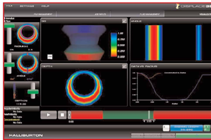
Figura 4.16 Muestra una representación gráfica de un programa de cómputo que modela la dinámica de los fluidos dentro del pozo. 47
