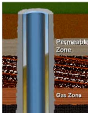
Figura #1. Colocación de la lechada de cemento. La lechada de cemento se comporta como un fluido. Transmite completamente la presión hidrostática.
