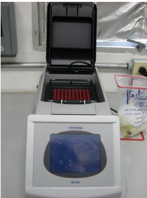
Fig. 4 Termociclador Techne TC-512 el cual puede ser programado para controlar la temperatura y los tiempos de reacción.
