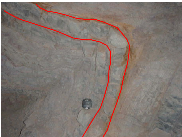
Figura 21. Intercalación de caliza-lutita de la formación Indidura (Kcet Cz-Lu) que muestra el reflejo de la estructura regional del anticlinal Cielo Azul; interior de mina Paulinita.
