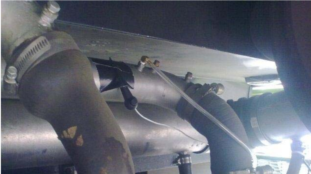
Imagen 4.2 Conexión del termopar al múltiple de entrada del motor (el termopar es pegado al múltiple por medio de cinta negra).
