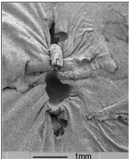
Fig. 33 Micrografía que revela excesiva fuerza al anudar la sutura 22
